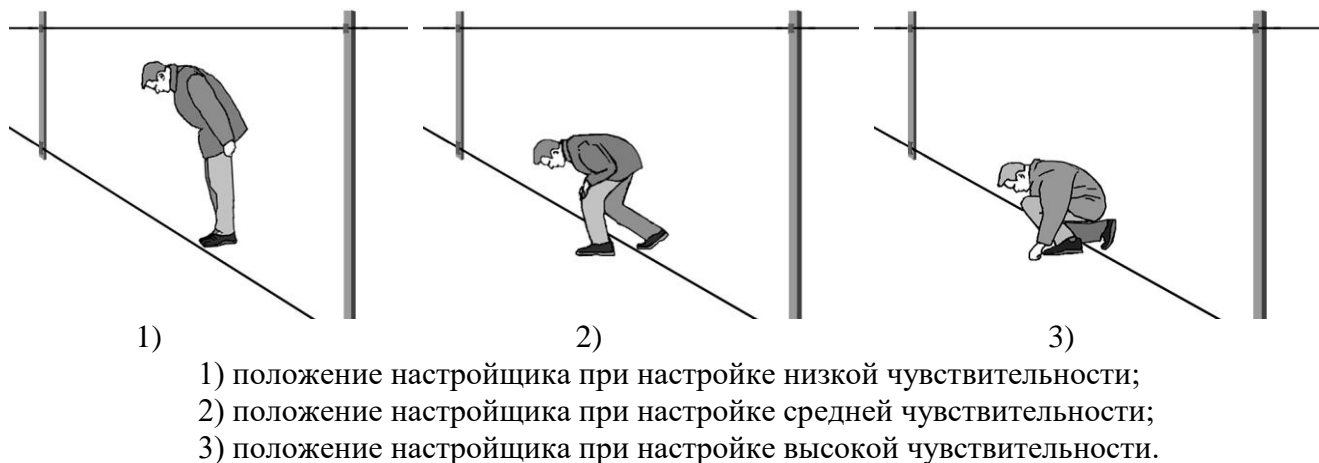
Рисунок 2.11 – Способы имитаций преодоления 30 при приземном варианте установки.
